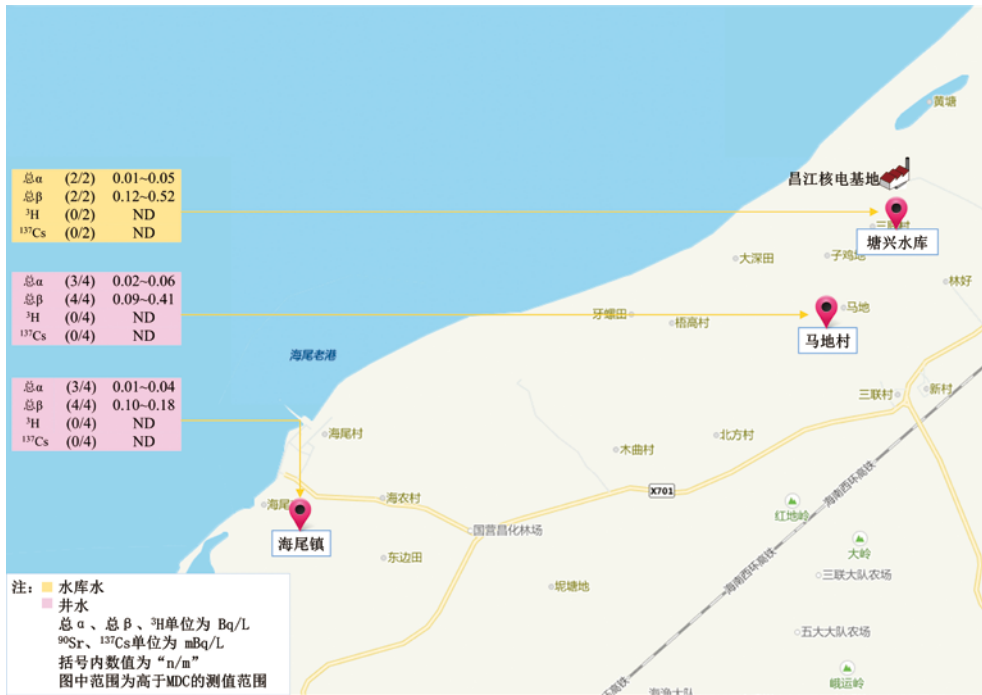
图 4.10-3 昌江核电基地周围水库水和井水监测结果分布示意图 (注：水库水和井水中其他人工γ放射性核素 54 Mn、 58 Co、 60 Co、 65 Zn、 95 Zr、 110m Ag、 124 Sb、 134 Cs、 144 Ce等均未检出。)
