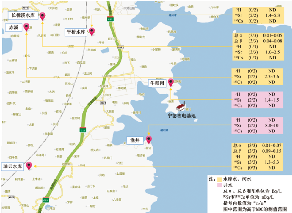
图 4.5-3 宁德核电基地周围水库水、河水和井水监测结果分布示意图
