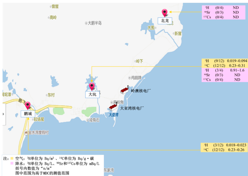
■ 图 4.7-2 大亚湾核电基地周围空气中碳-14、空气（水蒸汽）中氚和降水监测结果分布示意图
