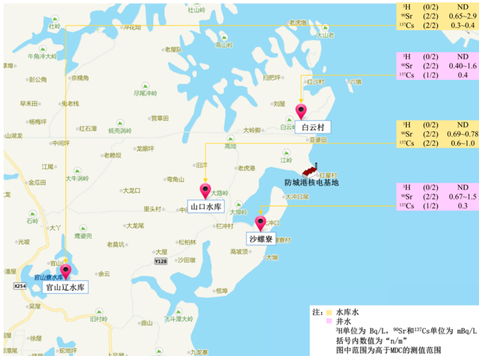
图 4.9-4 防城港核电基地周围水库水和井水监测结果分布示意图
