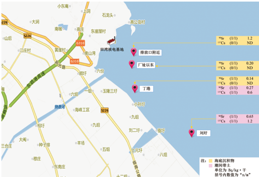
图 4.3-5 田湾核电基地周围海底沉积物和潮间带土监测结果分布示意图 (注：海底沉积物和潮间带土中其他人工 \gamma 放射性核素 ^{54}\text{Mn} 、 ^{56}\text{Co} 、 ^{60}\text{Co} 、 ^{95}\text{Zr} 、 ^{110\text{m}}\text{Ag} 、 ^{134}\text{Cs} 、 ^{144}\text{Ce} 等均未检出。)
