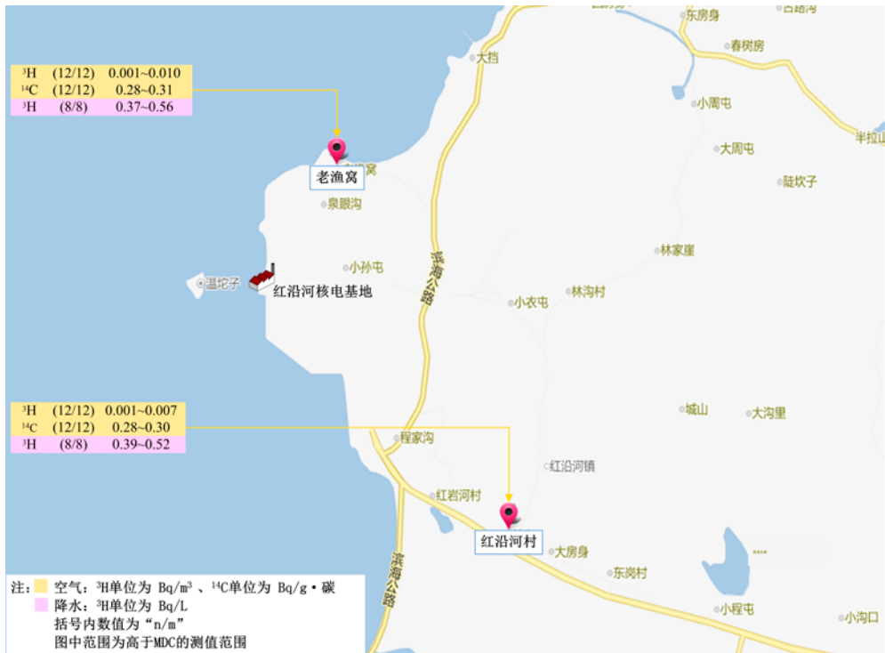
图 4.2-2 红沿河核电基地周围空气中碳-14、空气（水蒸汽）和降水中氚监测结果分布示意图
